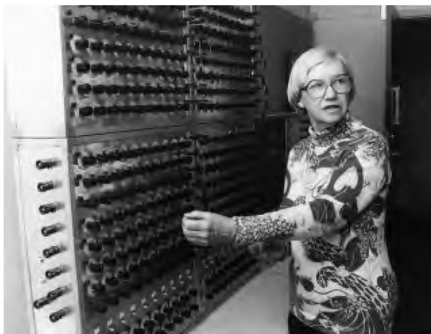
FIGUR 11. Apparat til sproglydssyntese på Fonetisk Laboratorium, demonstreret af Eli Fischer-Jørgensen 1981.
